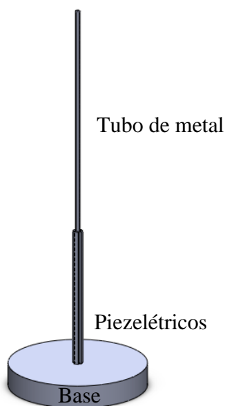
Figura 3 - Estrutura da bomba centrífuga utilizando movimento oscilatório de um tubo de metal
