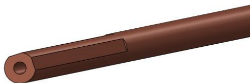
Figura 16 - Resultado da operação booleana entre o cilindro as pastilhas
