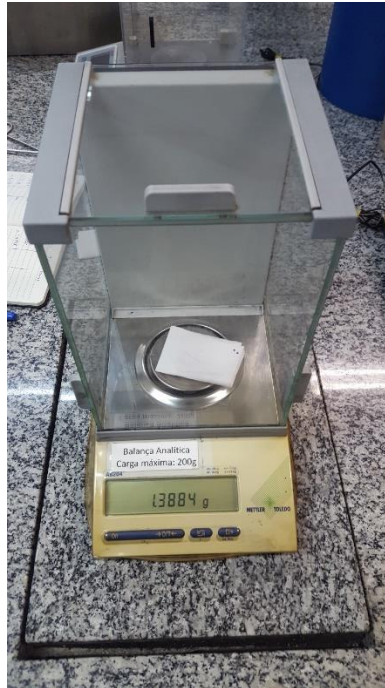
Figura 79 – Procedimento de pesagem na balança de precisão do papel absorvente
